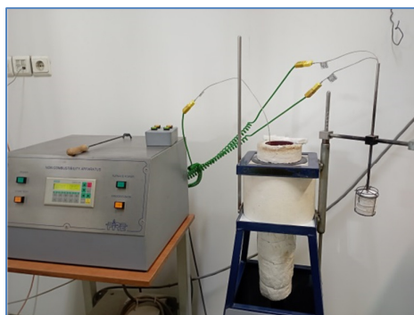
شکل ۵-۱- دستگاه اندازه‌گیری قابلیت نسوختن مواد
